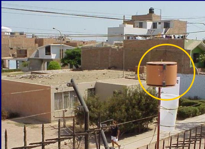
**Se dispuso de tubos pasivos para medir gases ( $O_3$ ,  $NO_2$  y  $SO_2$ ) de manera simultánea en 30 sitios distribuidos en el Area Metropolitana de Lima y Callao**
